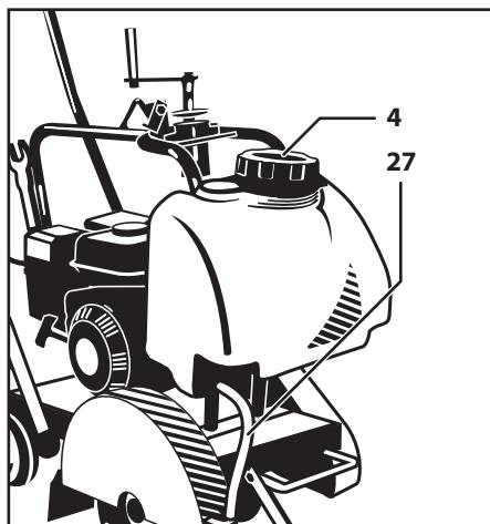
Для заливки воды, обеспечивающей снижение уровня пыли:
